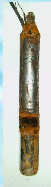
Eisen- und / oder Manganoxide tragen auch zu Verockerungen der Brunnen und der Pumpen bei. Verockerungen im Brunnen verkürzen die Lebensdauer der Brunnen und Verockerungen an den Förderpumpen erhöhen deren Wartungs- und Reparaturaufwand.
