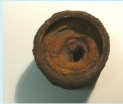
In den Rohren lagern sich Eisen- und / oder Manganoxide ab, die allmählich den Querschnitt reduzieren.
